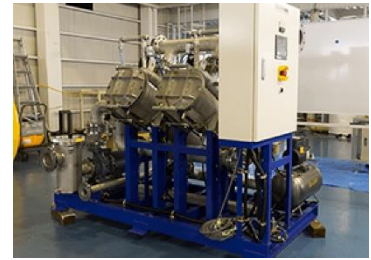
純水ユニットおよび水処理設備制作 （出所）ナカテック HP より
