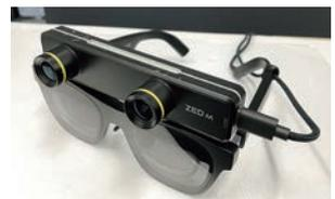
図3 軽量ARグラスを利用する遠隔作業支援・訓練システム
