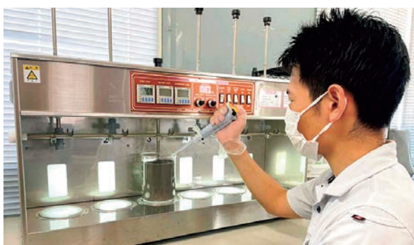
自社試験設備における薬品選定の様子
