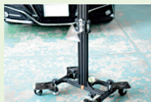
バンパー類も専用の調整器具でエーミング
