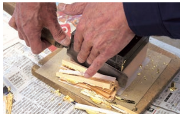
断切では、約1000枚の金箔を重ねたところで、四辺を紙ごと断って規定の大きさにする
