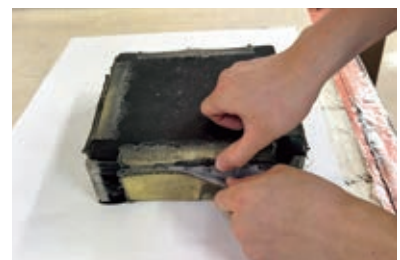
アラミド繊維を使用したベルトで固定し箔打ちの準備をする様子
