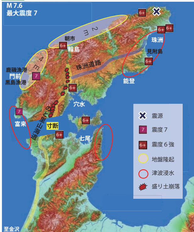
図1 交通が遮断され“離島”と化した能登半島の被災状況
