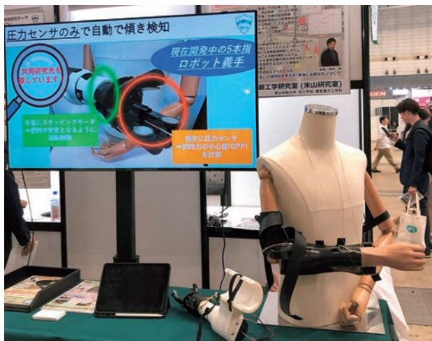
図13 開発中の能動義手
